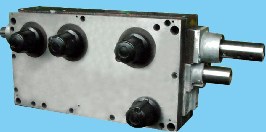
С помощью коробки подач осуществляются необходимые для эффективной и производительной работы относительные перемещения режущего инструмента и заготовки, обеспечивающие получение деталей нужной конфигурации с требуемыми точностью и чистотой обработанной поверхности.
